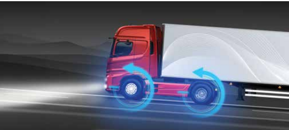
BERGANFAHRHILFE Verhindert das Zurückrollen beim Anfahren am Hang und unterstützt beim Halten des Fahrzeugs beim Bremsen oder auf rutschigen Strassen.
