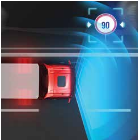
TRAFFIC SIGN RECOGNITION Erkennt Geschwindigkeitsbegrenzungen mittels Kamera- und Navigationsdaten, warnt bei Verstössen und greift gegebenenfalls ein.
