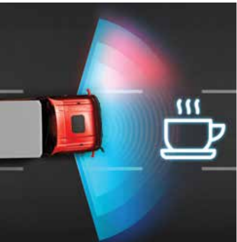
DRIVER ALERT SYSTEM Verwendet kamerabasierte Analyse, um Ablenkung des Fahrers zu erkennen, und vermindert potenzielle Risiken durch frühzeitige Warnungen.
