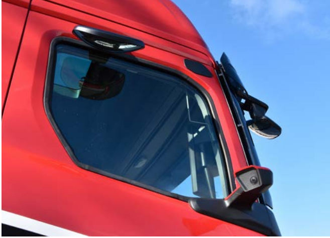
Der Rampenspiegel bleibt physisch bestehen, Seitenspiegel und Frontspiegel können als Kamera bestellt werden.
